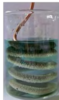
Слика 5.1. Редокс реакција меѓу Cu и AgNO 3
