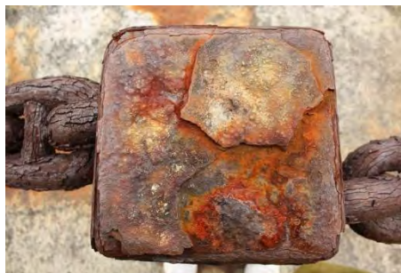
Слика 5.7. Корозија на железен предмет
